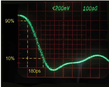
Fig 4 FAST NIM fall time
