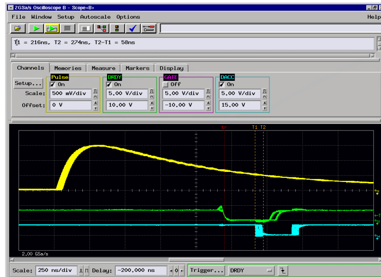
Fig. 8.16: ADC port handshake
