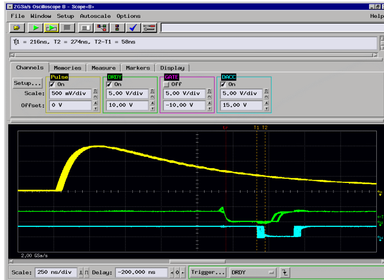
Fig. 8.4: ADC port handshake
